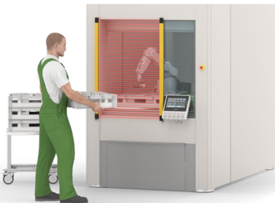
Zugangsabsicherung mit den Sicherheitslichtvorhängen SLC4
