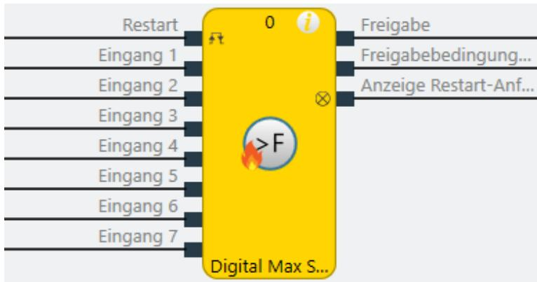
Abb. 255: Logische Anschlüsse für den Funktionsblock Digital Max Strömung
