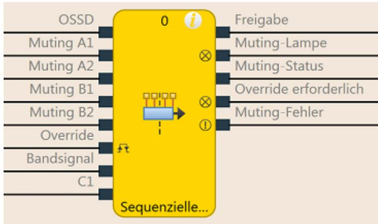
Abb. 135: Logische Anschlüsse für den Funktionsblock Sequenzielles Muting
