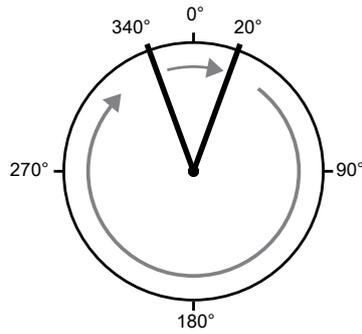
Abb. 204: Beispiel Positionswert mit Modulo bei Umdrehungen
