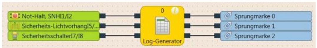
Abb. 85: Konfigurationsbeispiel für Log-Generator mit zwei Not-Halt-Tastern und einem Sicherheits-Schalter
