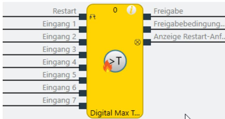
Abb. 259: Logische Anschlüsse für den Funktionsblock Digital Max Temperatur
