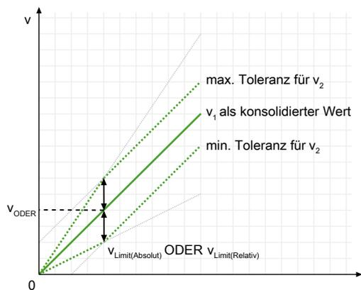
Abb. 190: Vergleichsmodus Absolut oder Relativ (mit Eingang 1 als Konsolidierung)
