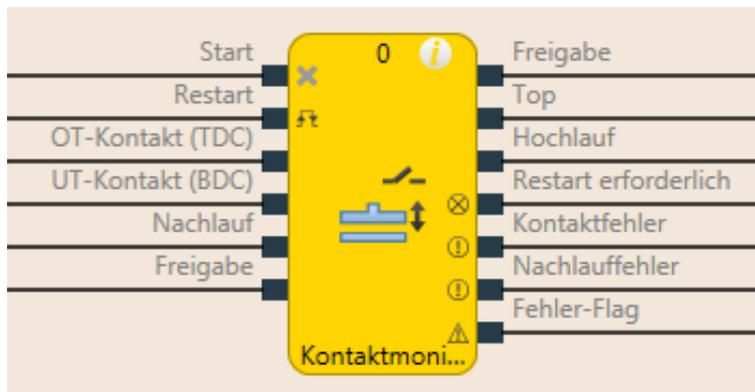
Abb. 150: Logische Anschlüsse für den Funktionsblock Kontaktmonitor Universalpresse
