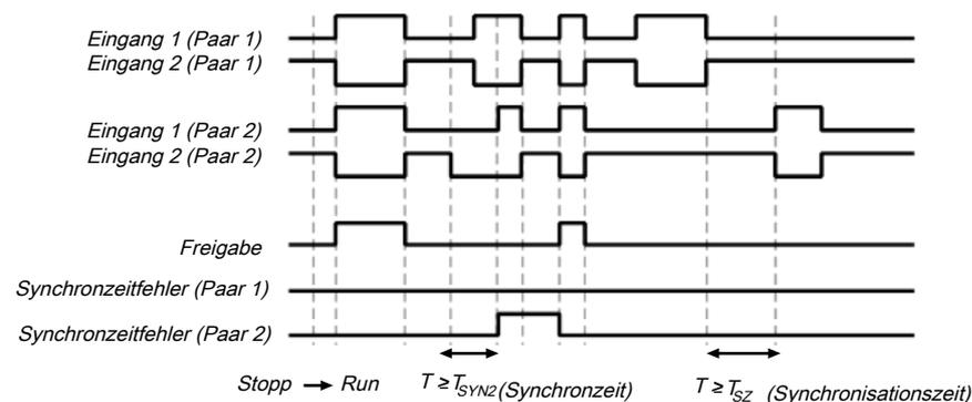
Abb. 126: Ablauf-/Timingdiagramm für den Funktionsblock Zweihand Typ IIIC
