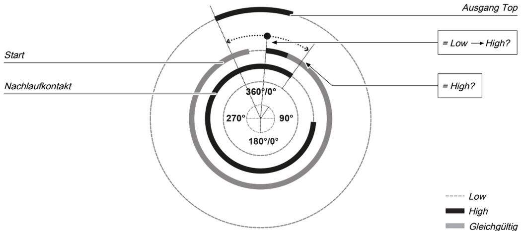
Abb. 156: Nachlaufüberwachung mit dem Funktionsblock Kontaktmonitor Universalpresse
