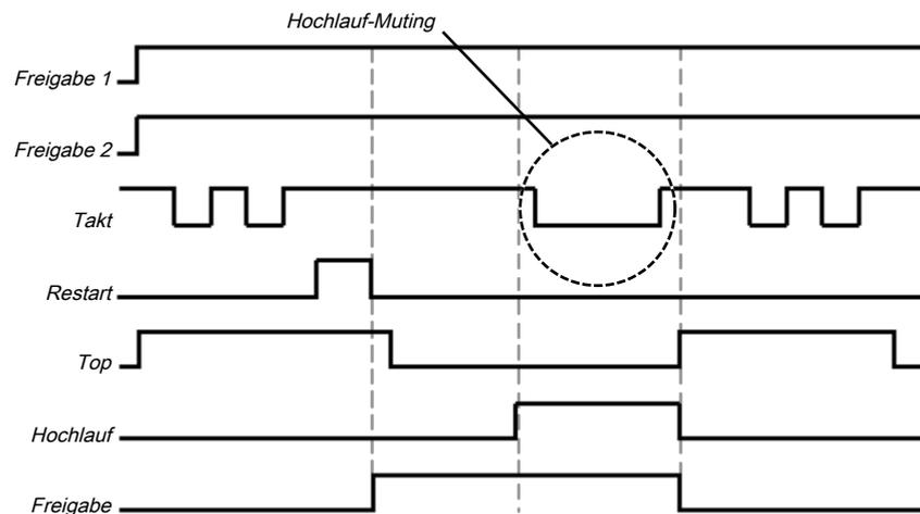
Abb. 173: Ablauf-/ Timingdiagramm für Hochlauf-Muting im Standard-Modus im Zweitaktbetrieb
