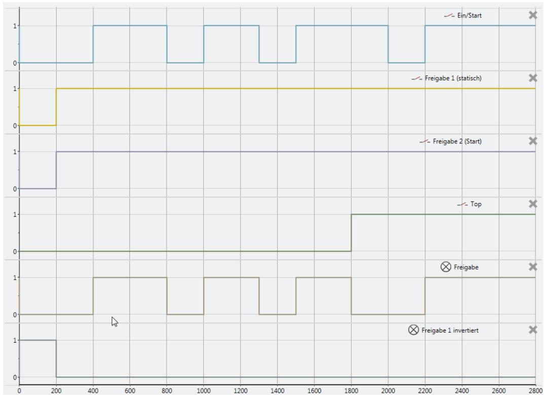
Abb. 160: Typisches Ablauf-/Timingdiagramm für den Funktionsblock Presse Einrichten
