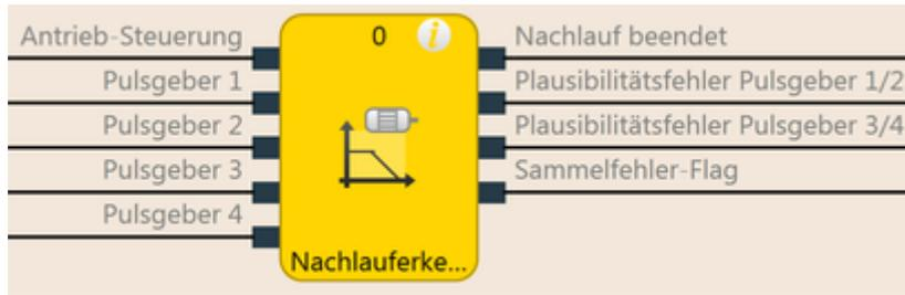
Abb. 110: Logische Anschlüsse für den Funktionsblock Nachlauferkennung
