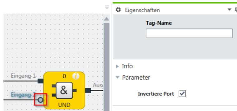
Abb. 58: Beispiel eines UND-Funktionsblocks mit einem invertierten Eingang
