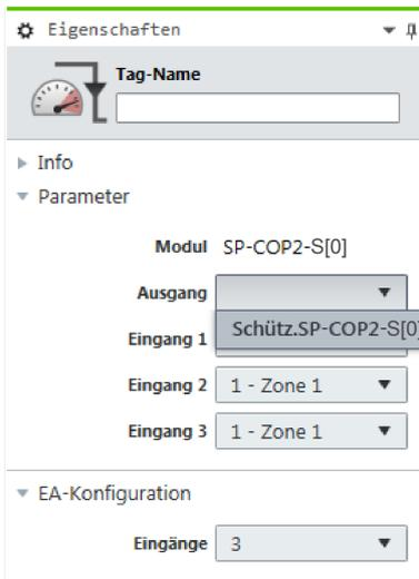
Abb. 76: Ausgang für Fast Shut Off anwählen
