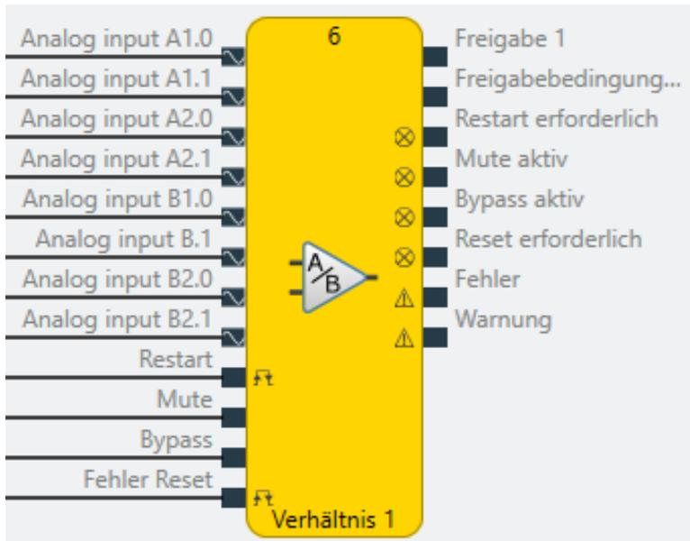
Abb. 219: Logische Anschlüsse für den Funktionsblock Verhältnis
