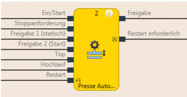
Abb. 167: Logische Anschlüsse für den Funktionsblock Presse Automatik
