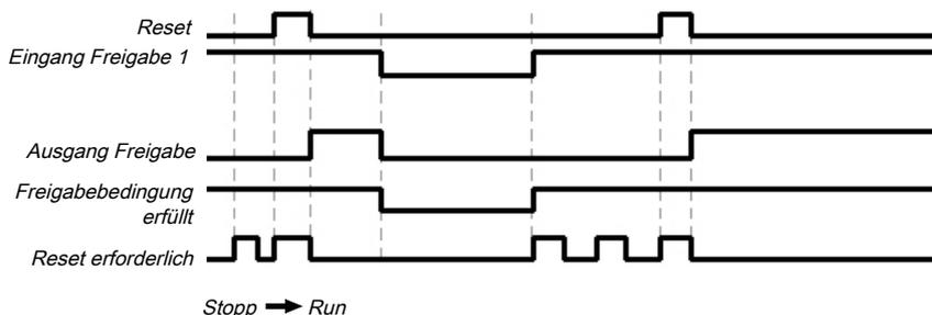
Abb. 252: Ablauf-/Timing-Diagramm für den Funktionsblock
