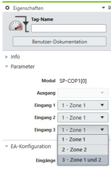
Abb. 75: Parametereinstellungen für den Funktionsblock Fast Shut Off
