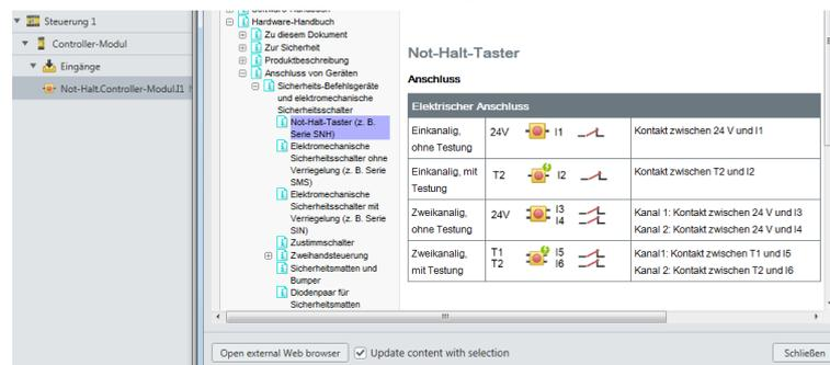
Abb. 17: Programmhilfe zum gewählten Objekt "Not-Halt-Taster"
