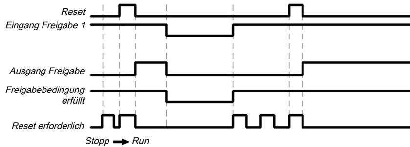
Abb. 93: Ablauf-/Timingdiagramm für den Funktionsblock Restart
