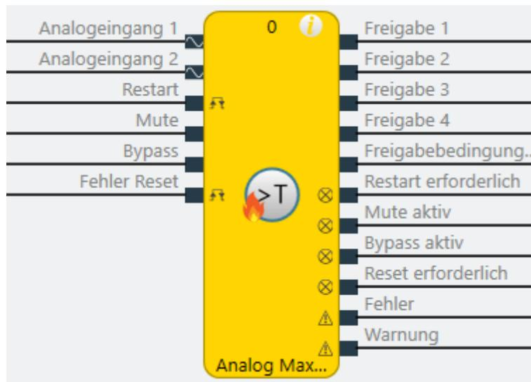
Abb. 241: Logische Anschlüsse für den Funktionsblock Analog Max Temperatur
