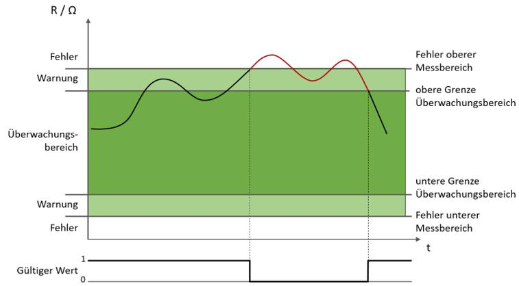
Abb. 55: Beispiel: Wert überschreitet den Überwachungsbereich (Sensor RTD)
