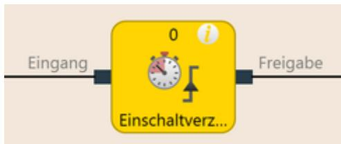
Abb. 98: Funktionsblockdiagramm für den Funktionsblock Einschaltverzögerung
