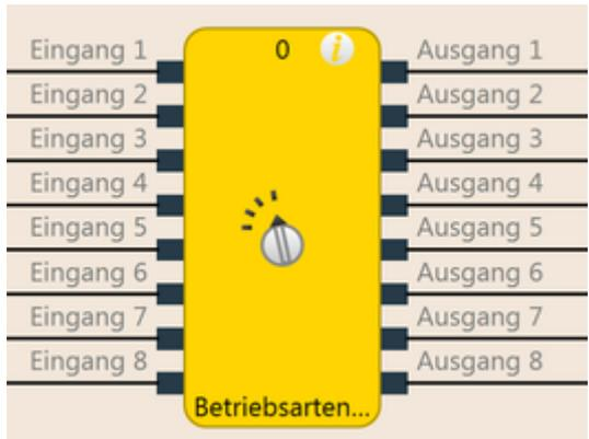
Abb. 108: Funktionsblockdiagramm für den Funktionsblock Betriebsartenwahlschalter
