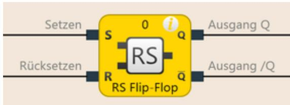
Abb. 65: Logische Anschlüsse für den Funktionsblock RS Flip-Flop
