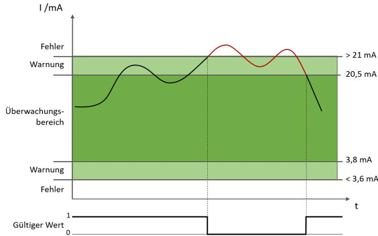
Abb. 53: Beispiel: Wert überschreitet den Überwachungsbereich (Sensor 4-20mA)
