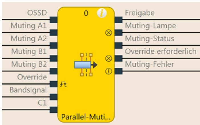
Abb. 132: Logische Anschlüsse für den Funktionsblock Parallel-Muting
