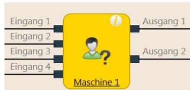
Abb. 40: Logische Anschlüsse für den benutzerdefinierten Funktionsblock
