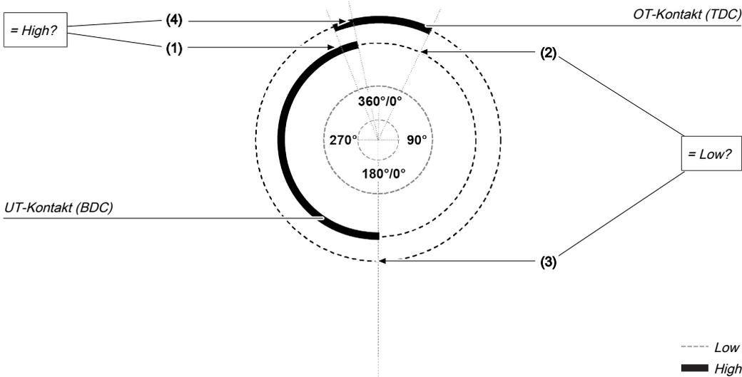
Abb. 145: Kontaktüberwachung mit dem Funktionsblock Kontaktmonitor Exzenterpresse
