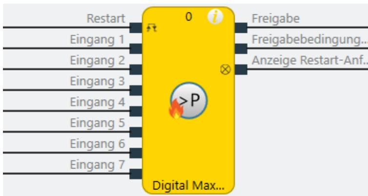
Abb. 251: Logische Anschlüsse für den Funktionsblock Digital Max Druck
