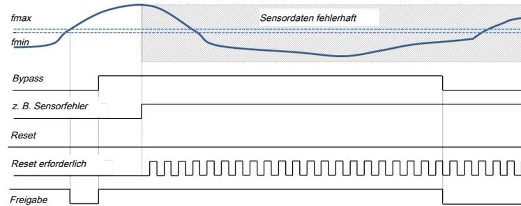
Abb. 209: Diagramm: Fehler bleibt nach der Deaktivierung vom Bypass bestehen
