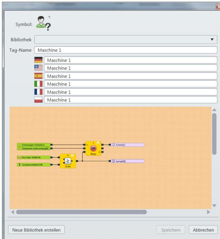
Abb. 41: Dialog Funktionsblockdetails editieren für den benutzerdefinierten Funktionsblock
