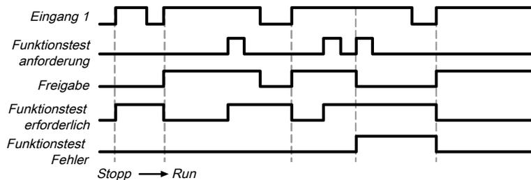
Abb. 122: Ablauf-/Timingdiagramm für Funktionsblock Schalter-Auswertung, Kategorie 2, einkanalig mit Funktionstest
