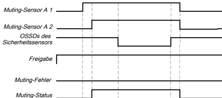
Abb. 143: Gültige Muting-Sequenz bei Benutzung der Konfigurations-Grundeinstellung
