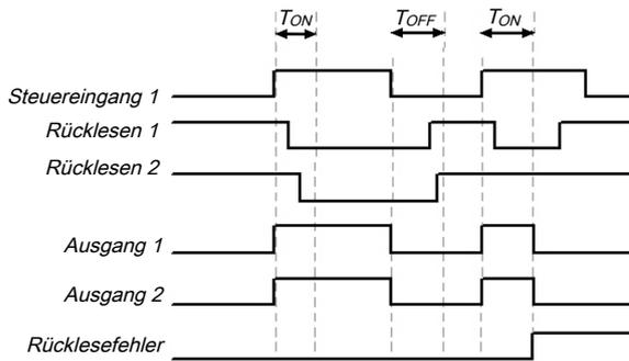
Abb. 106: Ablauf-/Timingdiagramm für Doppelventil im manuellen Resetmodus
