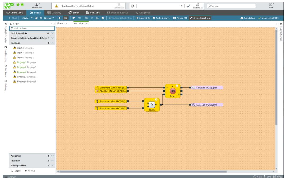
Abb. 39: Gruppiertes Funktionsblock mit angeschlossenen Geräten
