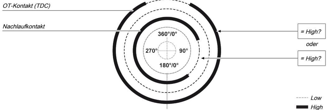
Abb. 151: Kontaktüberwachung mit dem Funktionsblock Kontaktmonitor Universalpresse mit aktiviertem Nachlauf
