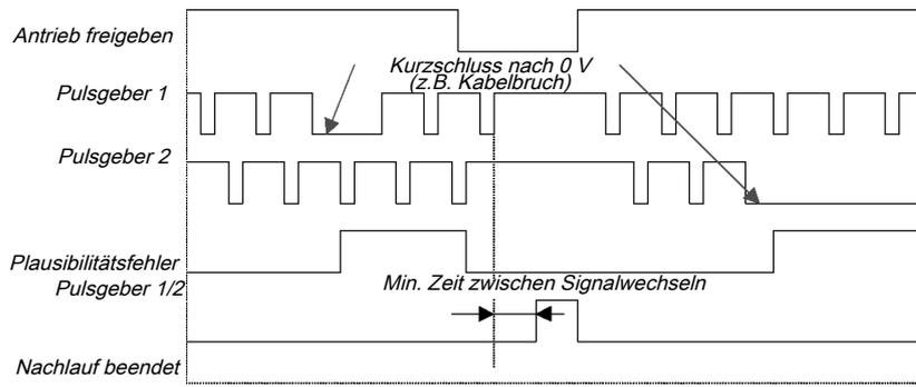
Abb. 116: Ablauf-/Timingdiagramm für den Funktionsblock 'Nachlauferkennung mit Plausibilitätsprüfung'
