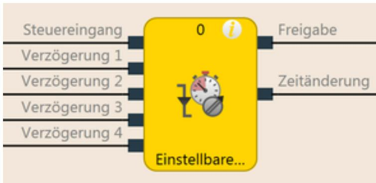
Abb. 96: Funktionsblockdiagramm für den Funktionsblock Einstellbare Abschaltverzögerung
