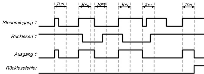
Abb. 105: Ablauf-/Timingdiagramm für Einzelventil im manuellen Resetmodus
