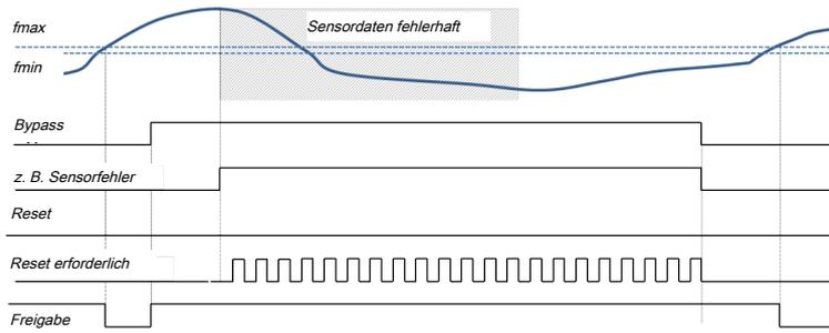
Abb. 208: Diagramm: Fehler wird während der Bypass-Zeit behoben
