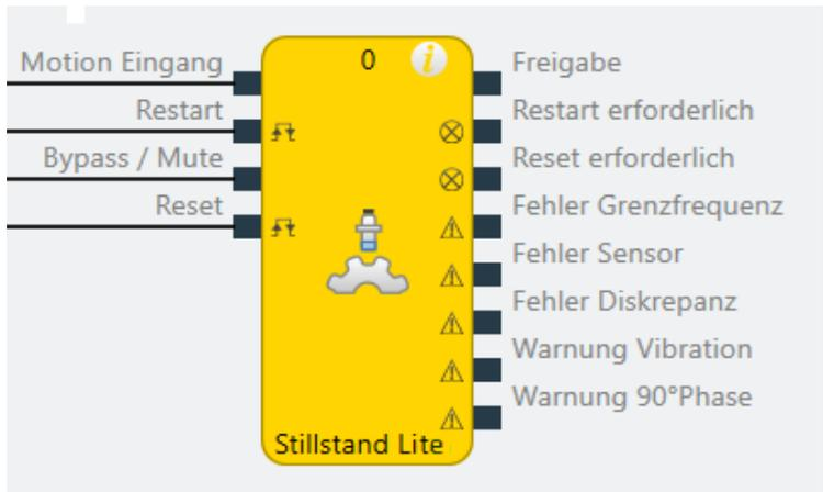
Abb. 205: Logische Anschlüsse für den Funktionsblock Stillstand Lite
