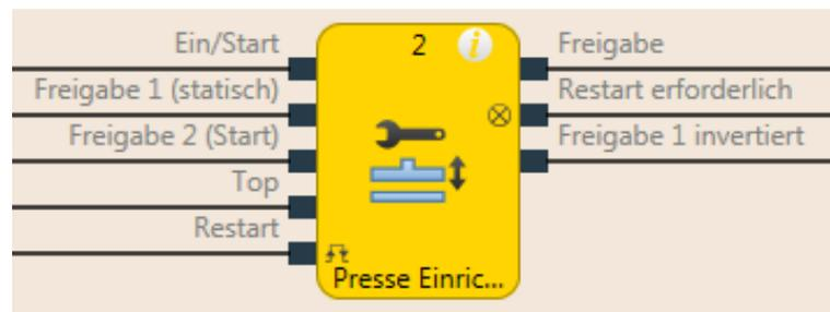
Abb. 159: Logische Anschlüsse für den Funktionsblock Presse Einrichten
