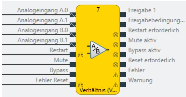
Abb. 221: Logische Anschlüsse für den Funktionsblock Verhältnis
