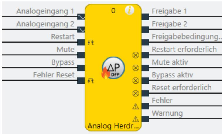
Abb. 246: Logische Anschlüsse für den Funktionsblock Analog Herdraumdruck
