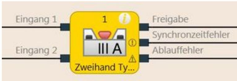
Abb. 124: Funktionsblockdiagramm für den Funktionsblock Zweihand Typ IIIA
