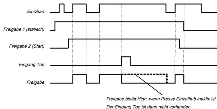
Abb. 161: Ablauf-/ Timingdiagramm für den Funktionsblock Presse Einrichten
