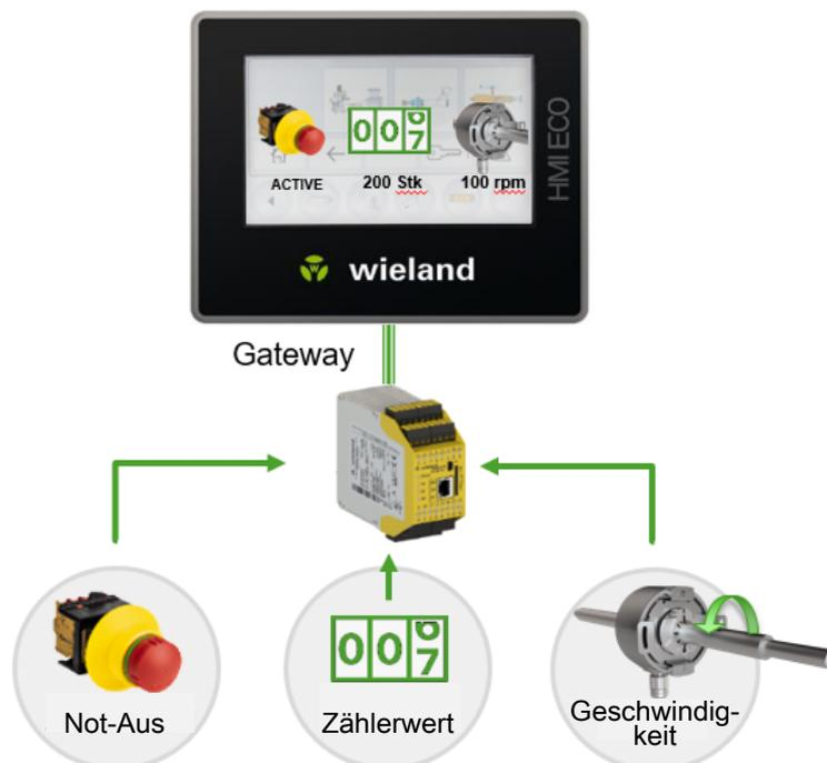
Abb. 8: Werte über Gateways zu HMI, SPS oder in die IIoT-Welt
