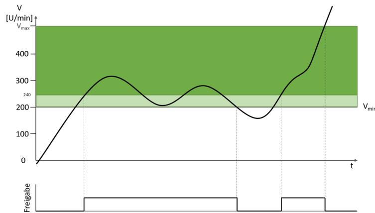
Abb. 200: SMS-Funktion überwacht eine Mindest-Drehzahl von 200 U/min. Hysterese 20%
