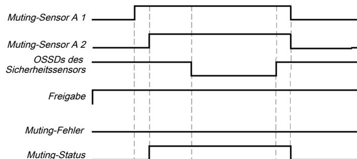
Abb. 140: Gültige Muting-Sequenz bei Benutzung der Konfigurations-Grundeinstellung
