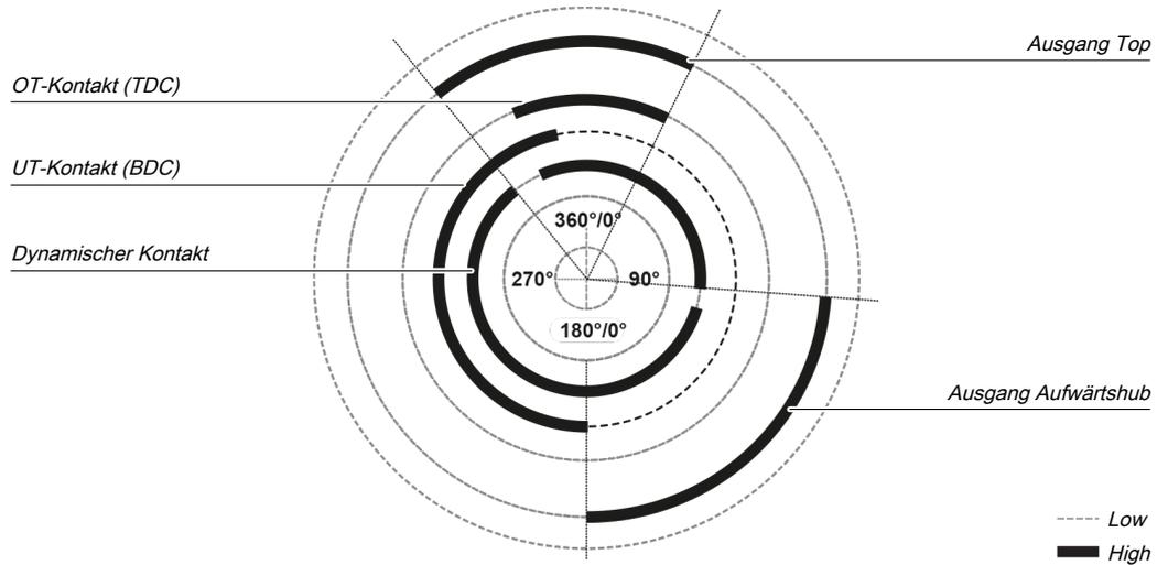
Abb. 148: Pressenzyklus für den Funktionsblock Kontaktmonitor Exzenterpresse mit Dynamischer Kontakt beim Hochlauf und bei der Abwärtsbewegung
