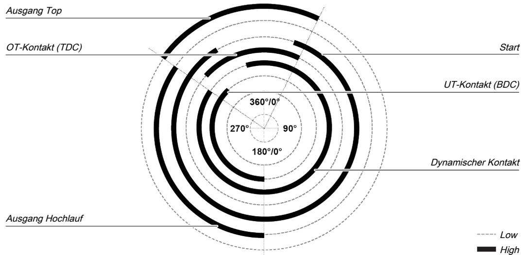
Abb. 158: Kontakt- und Ausgangsfolge einer Universalpresse bei einem fehlerfreien Ablauf (Beispiel)
