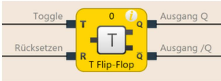
Abb. 64: Funktionsblockdiagramm für den Funktionsblock T-Flip-Flop
