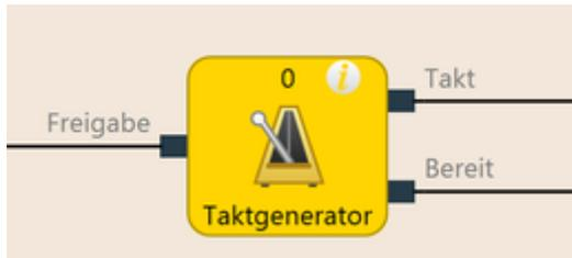
Abb. 67: Logische Anschlüsse für den Funktionsblock Taktgenerator
