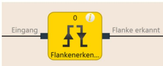
Abb. 79: Logische Anschlüsse für den Funktionsblock Flankenerkennung
