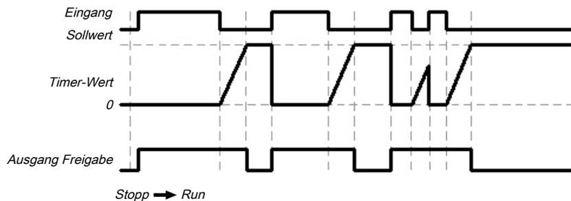
Abb. 95: Ablauf-/Timingdiagramm für den Funktionsblock Abschaltverzögerung
