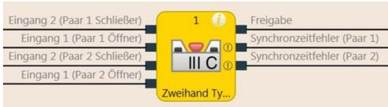
Abb. 125: Funktionsblockdiagramm für den Funktionsblock Zweihand Typ IIIC
