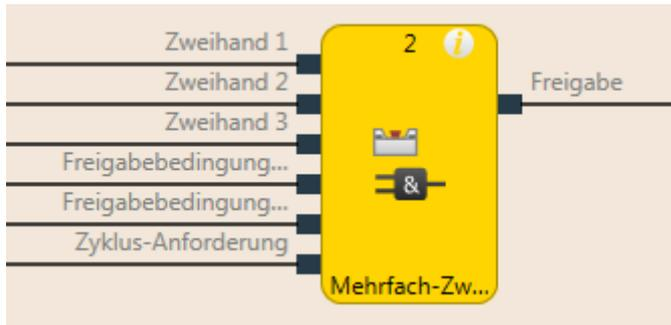
Abb. 127: Logische Anschlüsse für den Funktionsblock Mehrfach-Zweihand
