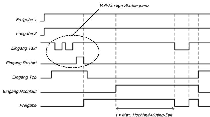
Abb. 176: Ablauf-/ Timingdiagramm, wenn der Eingang **Takt** Low, maximale Hochlauf-Muting-Zeit > 0 und Wiederanlaufsperrung auf **3 - Nach Stillstand im Abwärtshub oder Ausgangsstellung** gesetzt ist.
