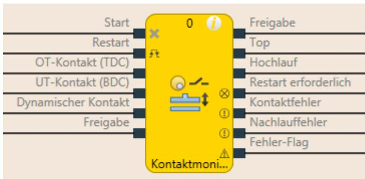
Abb. 144: Logische Anschlüsse für den Funktionsblock Kontaktmonitor Exzenterpresse
