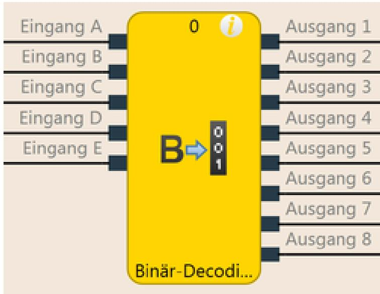
Abb. 82: Logische Anschlüsse für den Funktionsblock Binär-Decodierer
