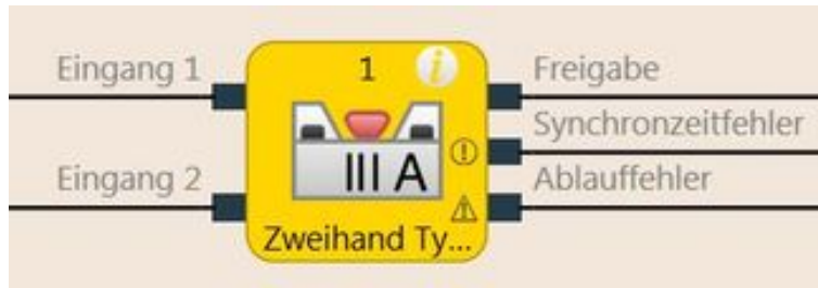
Abb. 119: Funktionsblockdiagramm für den Funktionsblock Zweihand Typ IIIA
