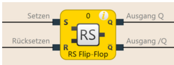
Abb. 60: Logische Anschlüsse für den Funktionsblock RS Flip-Flop
