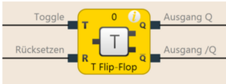
Abb. 59: Funktionsblockdiagramm für den Funktionsblock T-Flip-Flop
