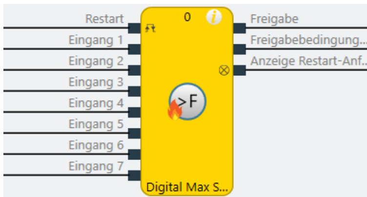
Abb. 250: Logische Anschlüsse für den Funktionsblock Digital Max Strömung
