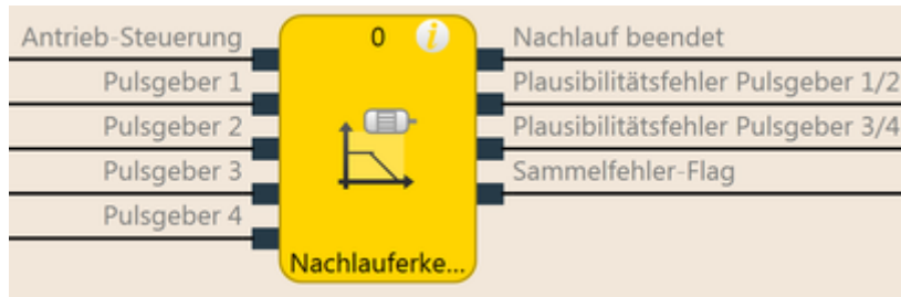
Abb. 105: Logische Anschlüsse für den Funktionsblock Nachlauferkennung
