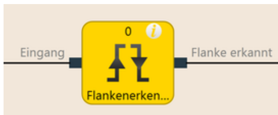
Abb. 74: Logische Anschlüsse für den Funktionsblock Flankenerkennung
