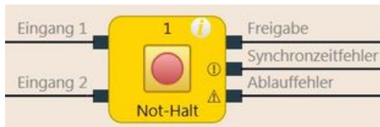
Abb. 112: Funktionsblockdiagramm für den Funktionsblock Not-Halt
