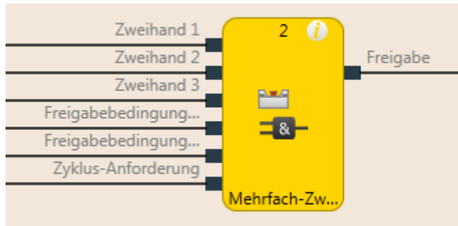
Abb. 122: Logische Anschlüsse für den Funktionsblock Mehrfach-Zweihand
