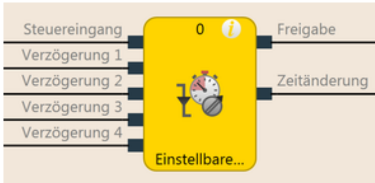
Abb. 91: Funktionsblockdiagramm für den Funktionsblock Einstellbare Abschaltverzögerung
