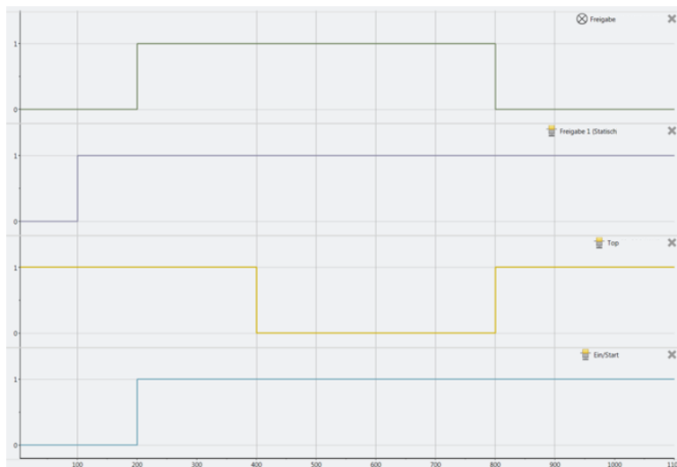
Abb. 158: Minimalistischer Ablauf Baustein Presse Einrichten
