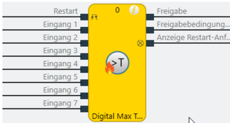
Abb. 254: Logische Anschlüsse für den Funktionsblock Digital Max Temperatur
