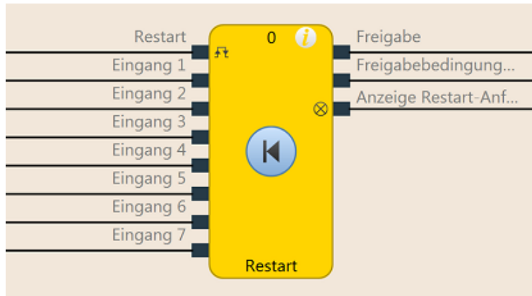
Abb. 87: Funktionsblockdiagramm für den Funktionsblock Restart
