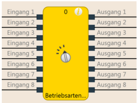
Abb. 103: Funktionsblockdiagramm für den Funktionsblock Betriebsartenwahlschalter
