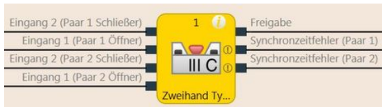
Abb. 120: Funktionsblockdiagramm für den Funktionsblock Zweihand Typ IIIC
