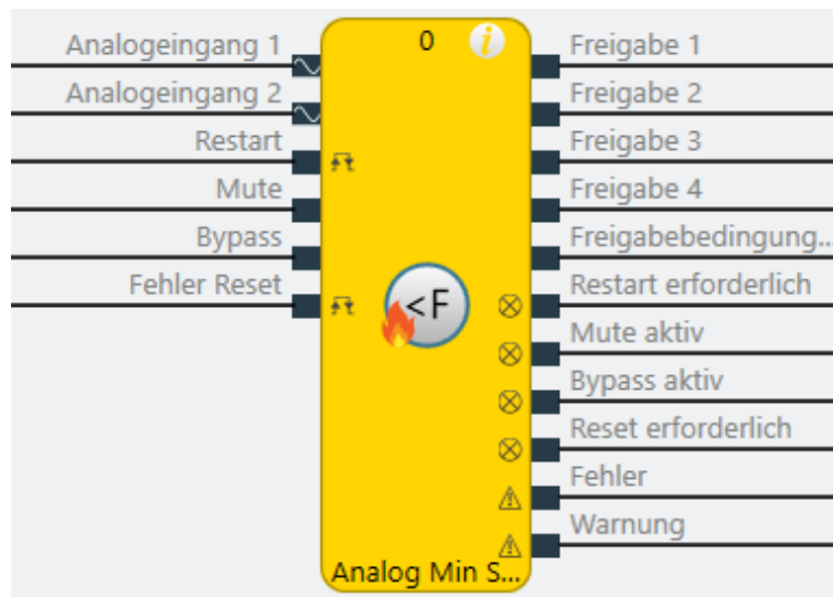
Abb. 227: Logische Anschlüsse für den Funktionsblock Analog Min Strömung
