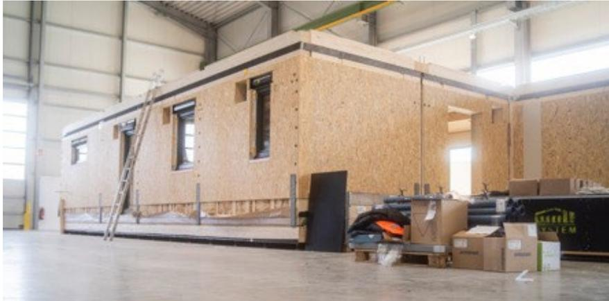
*Die Bauelemente der Fertighäuser werden bei der WOLF System GmbH in einer wettergeschützten Produktionshalle hergestellt. (Bild: Wieland Electric)*
