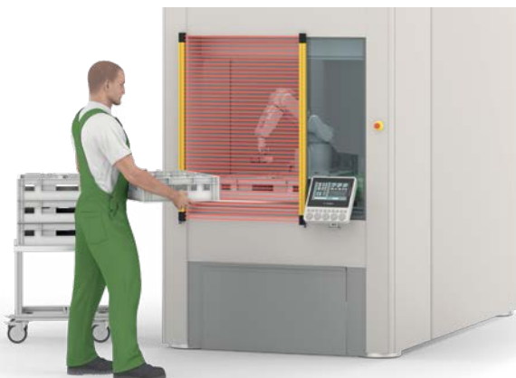
Zugangsabsicherung mit den Sicherheitslichtvorhängen SLC4
