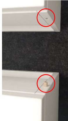
Abbildung 30: Passgenauer Sitz dank Positionsstift
