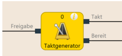
Abb. 55: Logische Anschlüsse für den Funktionsblock Taktgenerator
