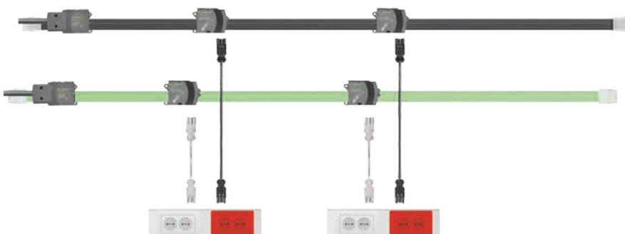
Abb. 02: Installationskonzept 2 x Energiebus, Stecksystem gesis® GST18i3 mit konfektionierten Leitungen, Geräteanschlüsse, Steckdosen (AV + SV).
