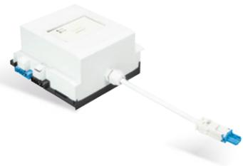
Die Spannungsversorgung dient der Versorgung von 24 V DC Verbrauchern und ist eingebaut in das auf Tragschiene montierbare AP-Gehäuse zum dezentralen Einbau. Sie ist nicht als KNX Spannungsversorgung geeignet. Die Netzversorgung erhält das Modul von einem vorgeschalteten gesis® FLEX Modul. Alle elektrischen Anschlüsse erfolgen steckbar nach IEC 61535.
