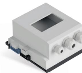
Das REG Modul ist systemkonform zum flachen, auf Tragschiene montierbare AP-Modulsystem zum dezentralen Einbau. Es kann Reiheneinbaugeräte nach DIN 43880 mit vier Teilungseinheiten aufnehmen. Vom vorgeschalteten Modul wird die Netz- und Busversorgung zum nächsten Modul weitergeleitet. Die Netzversorgung kann intern abgegriffen werden. Je nach Variante ist ein Klarsichtschutzdeckel zum Schutz der Einbauten angebracht, Kabeleinführungen bereits integriert oder bauseits einzubringen.
