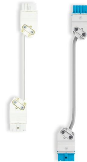
Die Verlängerungen für Netz und internen Bus für das flache, tragschiene montierbare AP-Modulsystem zum dezentralen Einbau dürfen im System eine Länge von maximal einem Meter haben. Sie verriegeln automatisch beim Stecken. Durch die mechanische Kodierung kann die Netzverbindung nicht mit der Busverbindung verwechselt werden.
