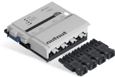
Der Relaisausgang 4-fach 230 V AC; 16 A im flachen, auf Tragschiene montierbaren AP-Gehäuse zum dezentralen Einbau wird vom Basismodul verwaltet. Er erhält seine Netz- und Busversorgung vom vorgeschalteten Modul. Der umfangreiche Parametersatz ermöglicht verschiedene Automationsfunktionen. Die Handbedienebene erlaubt Funktionstests ohne vorherige Systemintegration. Die nach IEC 61535 steckbaren, elektrischen Verbindungen trennen Automation und Installation.
