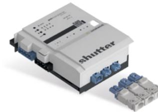
Der Jalousieausgang 2-fach 24 V DC; 3 A im flachen, auf Tragschiene montierbare AP-Gehäuse zum dezentralen Einbau wird vom Basismodul verwaltet und erhält die Busversorgung vom vorgeschalteten Modul. Die 24 V DC Versorgung erfolgt von extern. Der umfangreiche Parametersatz ermöglicht verschiedene Automationsfunktionen. Die Handbedienebene erlaubt Funktionstests ohne vorherige Systemintegration. Die nach IEC 61535 steckbaren elektrischen Verbindungen trennen Automation und Installation.
