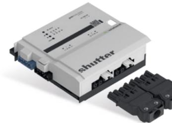
Der Jalousieausgang 2-fach 230 V AC; 8 A im flachen, auf Tragschiene montierbare AP-Gehäuse zum dezentralen Einbau wird vom Basismodul verwaltet. Er erhält seine Netz- und Busversorgung vom vorgeschalteten Modul. Der umfangreiche Parametersatz ermöglicht verschiedene Automationsfunktionen. Die Handbedienebene erlaubt Funktionstests ohne vorherige Systemintegration. Die nach IEC 61535 steckbaren elektrischen Verbindungen trennen Automation und Installation.
