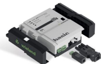
Das 1-phasig versorgte KNX Basismodul im flachen, auf Tragschiene montierbare AP-Gehäuse zum dezentralen Einbau unterstützt sechs Erweiterungsmodule. Sie verfügen über alle gängigen Ein-/Ausgänge und ermöglichen mit nur einer physikalischen Adresse eine umfassende Raumautomation. Die Handbedienebene erlaubt Funktionstests ohne vorherige Systemintegration. Die nach IEC 61535 steckbaren, elektrischen Verbindungen zu den Sensoren und Verbrauchern trennen Automation und Installation.
