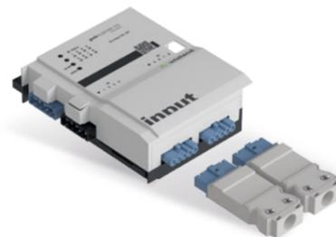
Der Binäreingang 8-fach 12 V DC (SELV) zum Anschluss potentialfreier Kontakte, im flachen, auf Tragschiene montierbare AP-Gehäuse zum dezentralen Einbau, wird vom Basismodul verwaltet. Er erhält seine Netz- und Busversorgung vom vorgeschalteten Modul. Der umfangreiche Parametersatz ermöglicht verschiedene Automationsfunktionen. Die Handbedienebene erlaubt Funktionstests ohne vorherige Systemintegration. Die nach IEC 61535 steckbaren, elektrischen Verbindungen trennen Automation und Installation.
