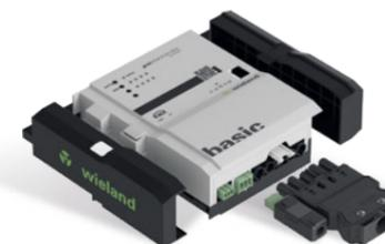
Das 3-phasig versorgte KNX Basismodul im flachen, auf Tragschiene montierbare AP-Gehäuse zum dezentralen Einbau unterstützt sechs Erweiterungsmodule. Sie verfügen über alle gängigen Ein-/Ausgänge und ermöglichen mit nur einer physikalischen Adresse eine umfassende Raumautomation. Die Handbedienebene erlaubt Funktionstests ohne vorherige Systemintegration. Die nach IEC 61535 steckbaren, elektrischen Verbindungen zu den Sensoren und Verbrauchern trennen Automation und Installation.
