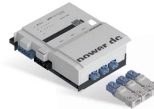
Das Netzteil 24 V DC; 30 W im flachen, auf Tragschienen montierbaren AP-Gehäuse zum dezentralen Einbau lässt sich an das Systems anreihen. Es erhält seine Netzversorgung vom Vorgängermodul und gibt die Netz- und Busversorgung an angereichte Module weiter. Der Ausgang ist parallel auf drei 2-polige Steckverbin der geführt.
