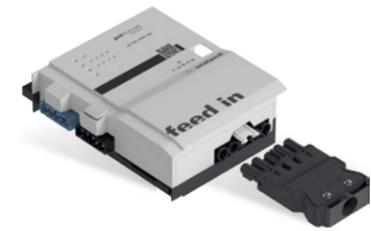
Die Zwischeneinspeisungen im flachen, auf Tragschiene montierbare AP-Gehäuse zum dezentralen Einbau erlauben innerhalb des modularen Systemaufbaus eine vom Basismodul getrennte Netz-Einspeisung. Damit können die Ausgangslasten auf verschiedene Sicherungskreise aufgeteilt werden. Es kann beliebig oft im System integriert werden. Die nach IEC 61535 steckbaren, elektrischen Verbindungen trennen Automation und Installation.
